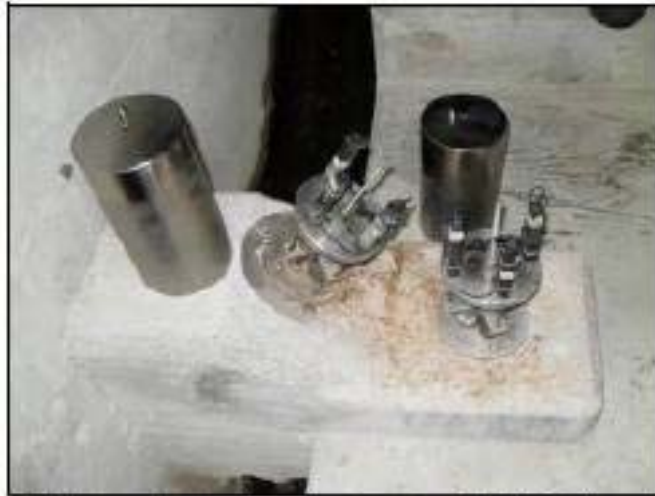
F 92. Extensómetro de varillas situado en B19 (G530)
